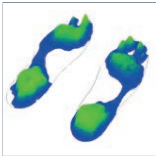
Fußdruckmessung: links Alltagsschuh, rechts Komet
