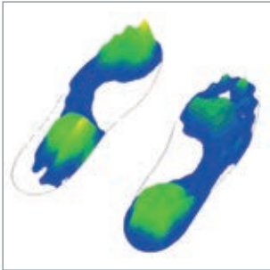
Fußdruckmessung: links Höhenausgleichsschuh, rechts Uranus
