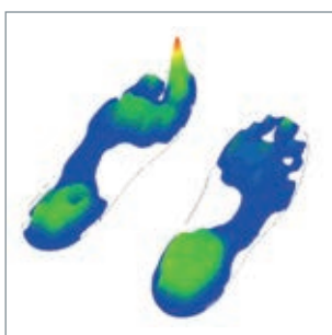
Fußdruckmessung: links Alltagsschuh, rechts Apollo
